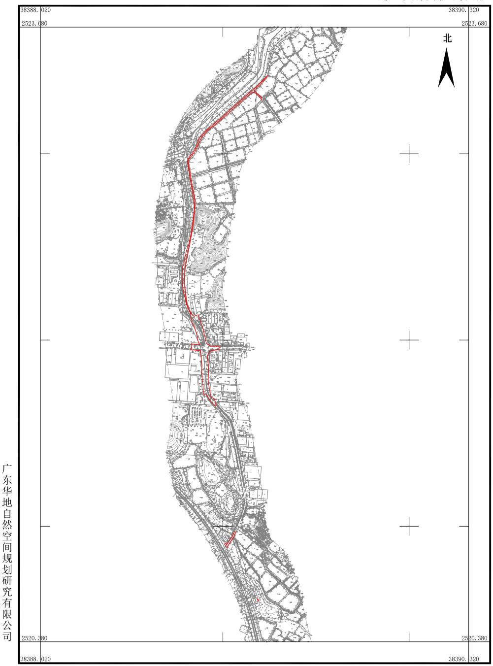
2000国家大地坐标系,中央子午线114度 1985年国家高程基准,等高距为0.5米 GB/T 20257.1-2017国家基本比例尺地图图式 第1部分: 1:500 1:1000 1:2000地形图图式 2023年4月数字化制图 测量员: 刘健强 绘图员: 谭世娴 检查员: 杨 团
