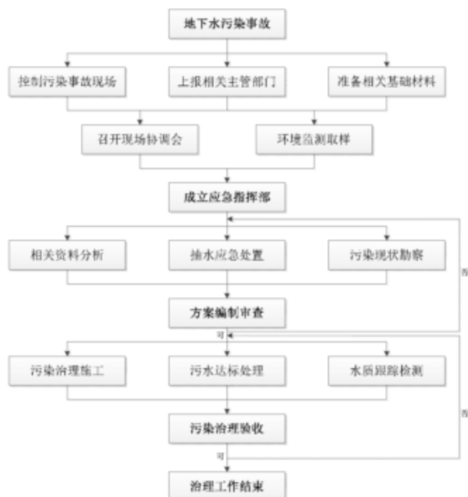
图 6.6-2 地下水污染应急治理程序
