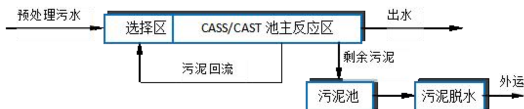
图 3.3-1 CASS/CAST 工艺基本流程
