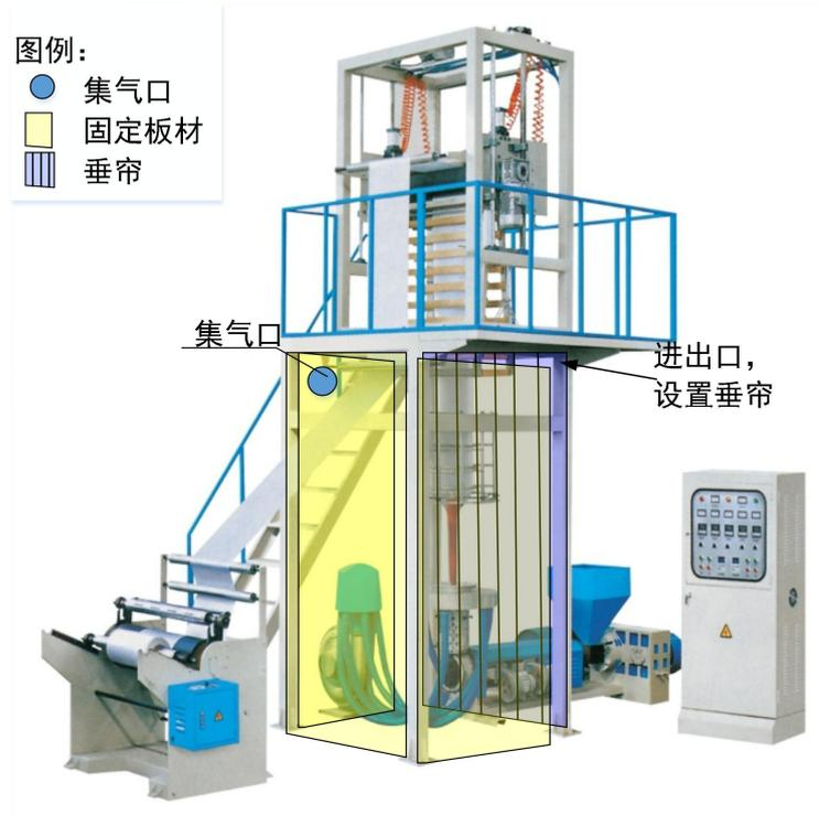
图 4-1 吹膜机废气收集示意图
