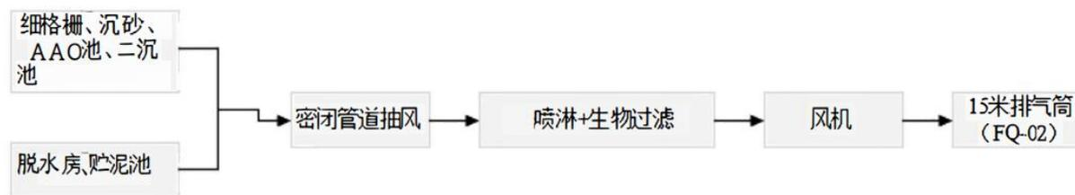
图 4-1 废气处理工艺流程图
