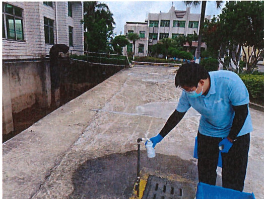
第二水厂出厂水采样口
